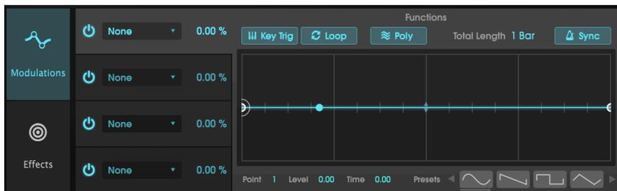
La section Modulation vous permet de générer jusqu'à quatre enveloppes très complexes, que vous pouvez ensuite utiliser pour moduler presque tous les paramètres d'OP-Xa V . Il ne s'agit pas de simples enveloppes typiques : ce sont des sources de modulation flexibles qui peuvent agir comme des enveloppes traditionnelles, des LFO ou même des séquenceurs pas à pas.
