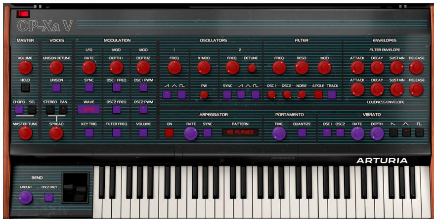
Cliquez sur un contrôle violet et son nom apparaîtra dans la liste. Puis, manipulez un contrôle ou faites fonctionner un interrupteur sur votre contrôleur MIDI. Le contrôle à l'écran correspondant deviendra rouge et le numéro de CC MIDI assigné apparaîtra dans la liste à gauche du nom du paramètre.
