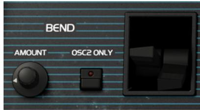
Cette section présente des contrôles de performance et les réglages des molettes Pitch Bend et Modulation. Vous pouvez ajuster ces contrôles à l'écran, mais ils sont mieux contrôlés par les molettes Pitch Bend et Modulation de vos claviers. Il s'agissait plus de leviers que de molettes sur le périphérique original, nous les avons donc restitués sur OP-Xa V .
