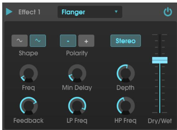
Le flanging peut créer des effets extrêmes et subtils, selon les paramètres Frequency et Depth de la modulation. Avec des réglages de Depth plus élevés, vous commencez à entendre des changements de hauteur dans le son. C'est ainsi que les circuits fonctionnent dans un Flanger analogique, et nous avons pris soin de recréer ces conditions dans notre logiciel.
