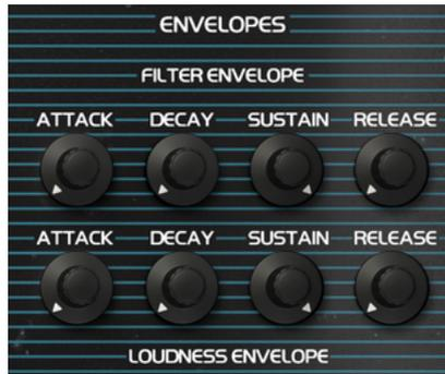
Cette partie contient les générateurs d'enveloppe, qui sont responsables de la sculpture de la « forme » du son fil du temps. Il y a une Loudness Enveloppe qui contrôle l'amplitude du signal, et il y a aussi une enveloppe du Filtre qui contrôle la Fréquence du filtre.
