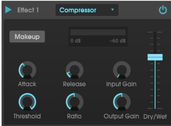
Si vous utilisez un compresseur dans une chaîne d'effets, il peut empêcher les transitoires d'un son de surcharger l'entrée de l'effet suivant. Il peut aussi refaçonner le contour d'un son qui décroît rapidement naturellement afin qu'il ait un sustain plus long. Les percussions sont souvent compressées pour ajouter un côté percutant. La compression est également ajoutée systématiquement aux niveaux audio de la radio et de la télévision pour les maintenir dans une certaine plage de volume.
