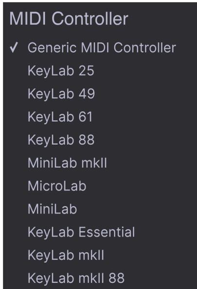
En haut à droite de l'onglet MIDI se trouve un menu déroulant permettant de sélectionner des modèles parmi les nombreux contrôleurs MIDI Arturia. Ils mappent les contrôles physiques vers de nombreux paramètres « très recherchés » dans Pigments pour une approche « prêt à l'emploi ». Un modèle générique est aussi fourni pour les contrôleurs MIDI tiers.
